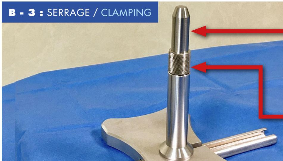
Le diamètre extérieur de cet axe correspond au diamètre interne de l'épée. L'un peut s'emboiter dans l'autre.
