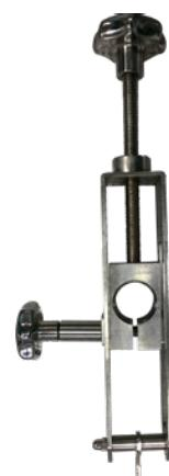
La longue vis de réglage du tendeur ne sert qu'à l'ajustement final de cette traction : tendre un peu plus ou un peu moins. C'est pourquoi, avant de créer une traction, le chariot du tendeur doit être réglé en position intermédiaire pour pouvoir travailler dans les deux sens.
