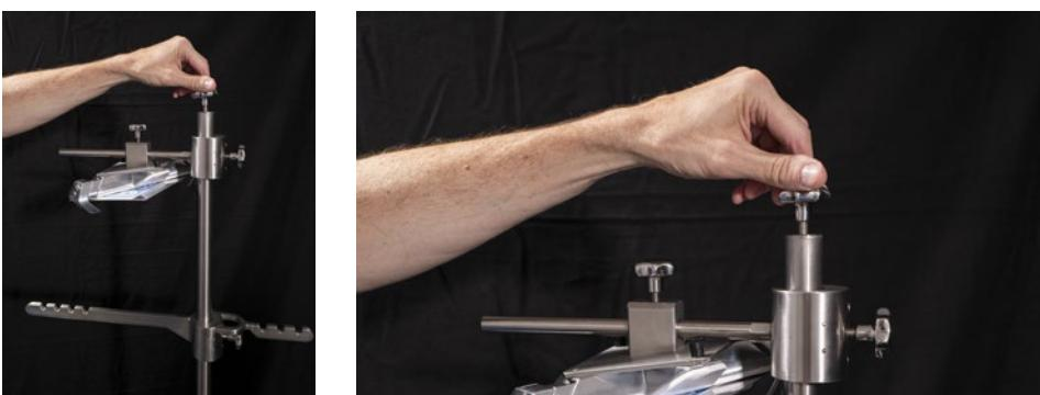
Enfin, si vous n'utilisez pas le matériel destiné à l'arthroscopie, remettez la vis sur le haut de la potence. Cette vis sert de réserve si une des autres vis venait à être perdue. De plus, par son diamètre, elle assure qu'aucun support ne puisse se désengager de la potence par inadvertance.
