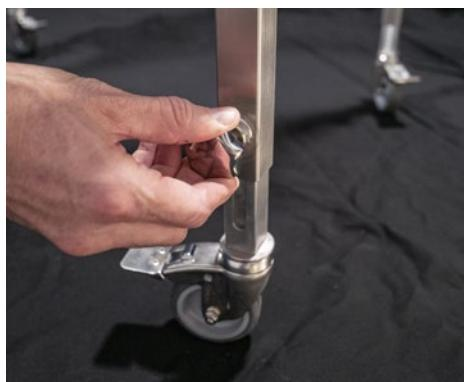
Mettez votre table de niveau grâce au pied réglable. Déverrouillez la vis et laissez la roue toucher le sol. Serrez alors la vis.
